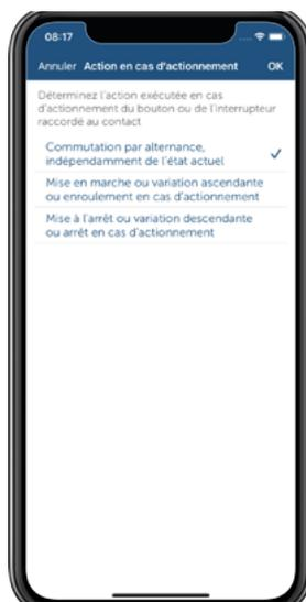
Figure 6: Action en cas d'actionnement du bouton
